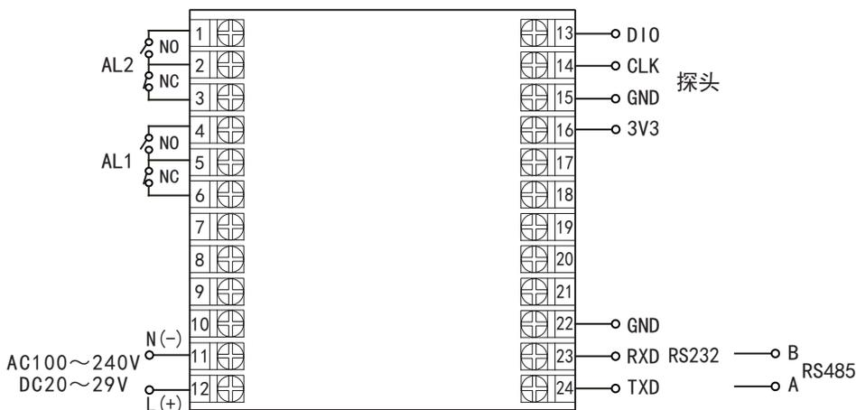
探头外部接线方法: 3V3—红色线, GND—黄色线, CLK—蓝色线, DIO—绿色线/黑色线
