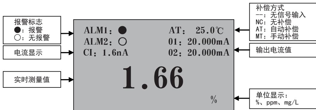
注：当测量值显示“———”时，表示超量程或电极没插入溶液中。
