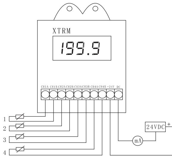
自热电阻传感器的测量信号通过前置放大器放大，然后被比较输入电路（选择高温信号）或选点输入电路选中某一路信号，该信号通过电流（V/I）转换单元将放大器的输出电压变为4-20mA恒定电流输出，原理方框图如下图所示：
