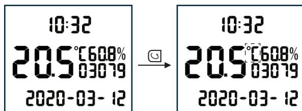
在正常运行界面下，按“”键时间值（时:分）闪烁，按“”键温度单位“ $^{\circ}\text{C}$ ”闪烁，再按一下“”键，用“”、“”键选择“ $^{\circ}\text{C}$ ”和“ $^{\circ}\text{F}$ ”，再按“”键确认。
