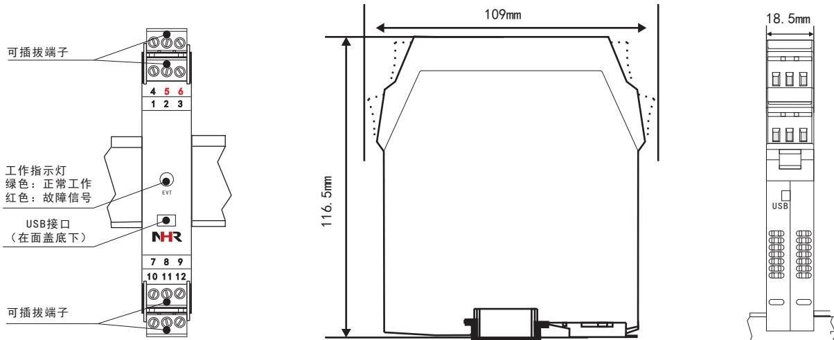
EVT: 工作指示灯：仪表正常工作时，指示灯为绿色；输入信号有故障报警时，指示灯为红色
