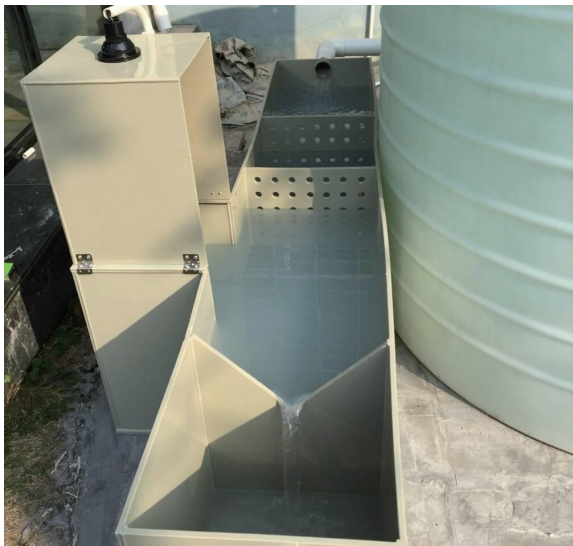
加装2层带孔的挡板来解决水面波动大
