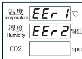
Err1: 温湿度传感器故障      Err2: 电流变送器输入故障
