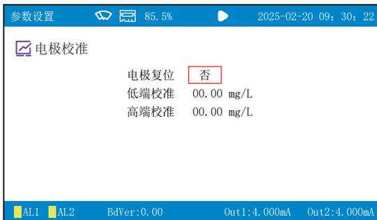
★电极复位：是、否可选，选择“是”复位电极校准值，提示“电极复位完成！”
