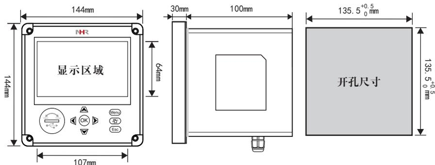
4.3、仪表安装方法：仪表可以盘装式或壁挂式安装。
