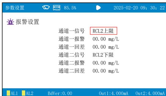
★通道一信号：RCL2下限、RCL2上限、温度下限、温度上限、无报警可选。
