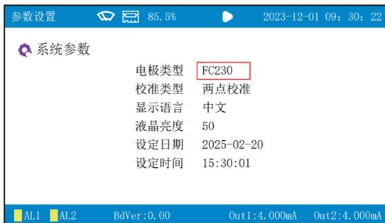
★电极类型：余氯电极：FC230（注：余氯电极：Rev-CL2，浊度电极：PTU630、PTU660、PTU800；污泥电极：PSS630、PSS660、PSS800为内部保留参数。）
