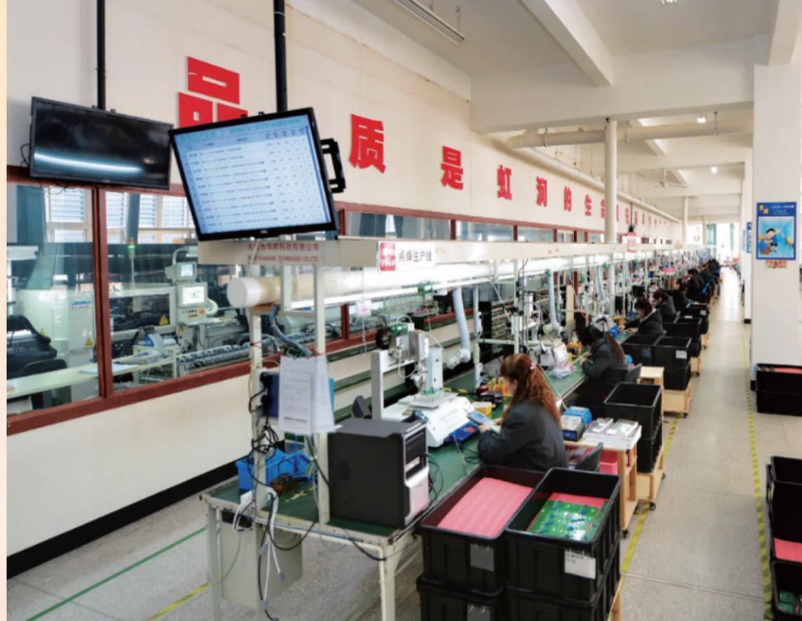
在生产的可视化管理上，我们开发了智能可视化管理系统，通过可视化电子看板，每一个产品的生产进度、返修率、合格率都一目了然，每一个零件和成品的去向都完全“清晰可见”。操作人员通过扫描生产流转单，可以实时在线查询与推送工序相关的作业指导书并确认工作内容。同时生产车间还安装了远程视频监控系统，这套可视化系统的数据和绩效考核挂钩，充分体现多劳多得。
