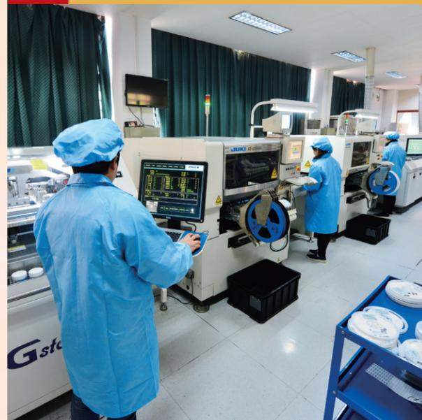
我们引进购入全自动高速贴片机、锡膏印刷机、回流焊机、波峰焊机等生产设备，提高了产品产量和质量，降低了出错率和损耗，提高了生产力，减轻了劳动强度。
