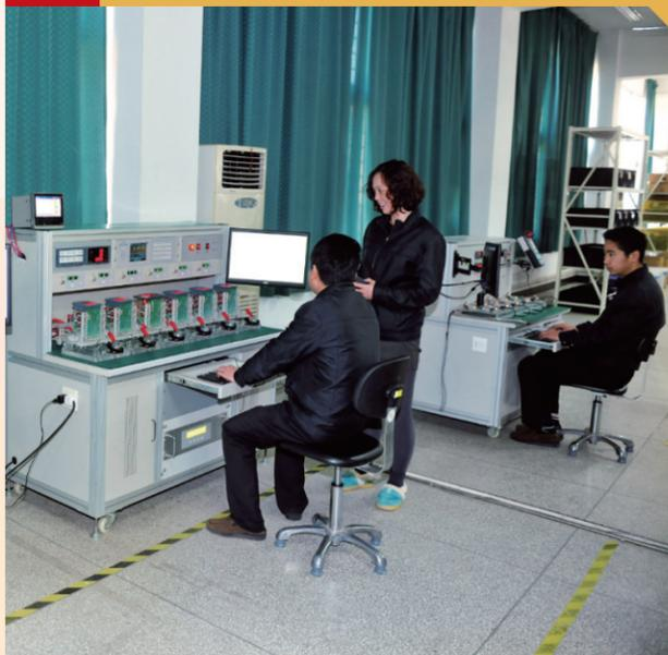
虹润产品有六大系列上千个品种，有些多通道的仪表可以做到 64 路通道的压力、温度监测，单纯的靠人工去校验耗时费力且容易出错。于是我们自主设计开发了自动校验仪表系统，一次可以校验 6 台仪表。由于产品种类多，所以自动校验仪表系统的开发工作非常复杂，很有难度。
