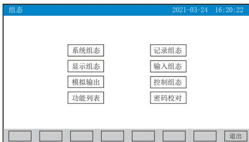
进入组态首先要进行密码校对，点击“密码校对”将出现一对话框，在对话框输入密码（对话框操作可参见第26页“六、T6输入法”一节）。密码由6位数据组成，出厂默认密码为000000，用户可以在“系统组态”——“用户密码”一栏修改校对密码。若密码输入错误，用户将不能进入各组态画面。
