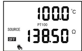
**注：在查表过程中，输出值即为查表值。如输出时R1ina, R2ina不等于0时，查询时已将电阻修正值计算在内，无须再次换算。（R1ina为400 Ω档电阻修正值，R2ina为4k Ω档电阻修正值）**
