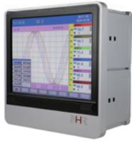
NHR-9700系列触摸数据采集控制工作站采用新型大规模集成电路，对输入、输出、电源、信号采取可靠保护和强抗干扰设计。70路万能信号输入（可组态选择输入：标准电压、标准电流、热电偶、热电阻、毫伏等）。可带20限报警输出，14路变送输出，6路DI输入，RS232/485通讯接口，以太网接口，微型打印机接口和USB接口，SD卡插座；可提供传感器配电；具有强大的显示功能，实时曲线显示，历史曲线追忆，棒图显示，报警状态显示。
