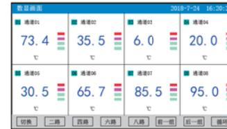
数据画面：显示实时测量值，同时还可显示通道位号、工程单位及报警状态等信息
