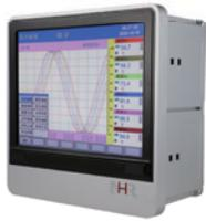
NHR-9100系列触摸中长图彩色无纸记录仪采用新型大规模集成电路，对输入、输出、电源、信号采取可靠保护和强抗干扰设计。14路万能信号输入（可组态选择输入：标准电压、标准电流、热电偶、热电阻、毫伏等）。可带20限报警输出，14路变送输出，6路DI输入，RS232/485通讯接口，以太网接口，微型打印机接口和USB接口，SD卡插座；可提供传感器配电；具有强大的显示功能，实时曲线显示，历史曲线追忆，棒图显示，报警状态显示。
