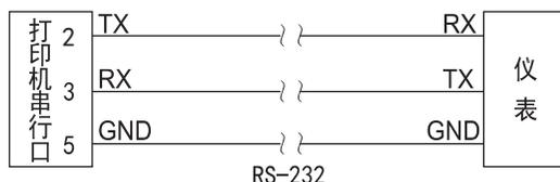
注：仪表与打印机的波特率必须相同（设定仪表波特率请参见仪表二级参数的设定，设定打印机波特率请参见打印机说明书）。
