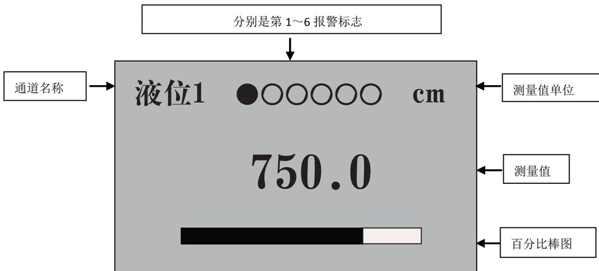
1: 以上的第一、二、三、四、五、六报警可根据用户需要, 根据组态菜单中报警选项设置所对应得报警触点, 可任意定义其中任何一个报警所对应(一、二)输入通道中的任何一个通道, 报警方式可任设上限或下限报警。
