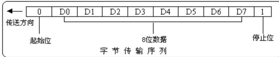
每字节含8位二进制码，传输时加上一个起始位(0)，一个停止位(1)，共10位。其传输序列如下图所示，D0是字节的最低有效位，D7是字的最高有效位。先传低位，后传高位。
