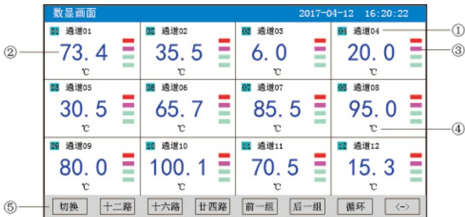
①、通道名称：表示显示通道对应的工程位号。可在“输入组态”——“位号”一栏进行设置。
