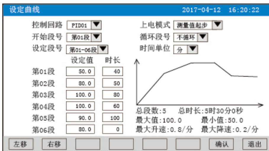
★控制回路：PID01 到 PID08 可选，共 8 回路。
