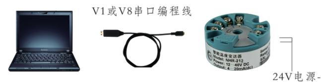
注：使用V8串口编程线时，无需24V供电
