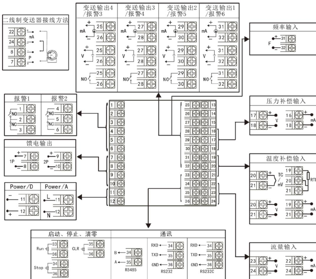
备注：接线图中在同一组端子标有不同功能的，只能选择其中一种功能如 RS485 和 RS232 在同一组接线端子上，只能选择一种。
