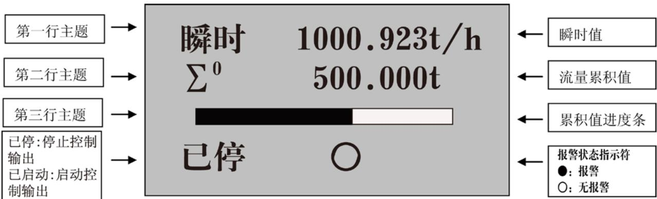
1: 启动方式为自动时，当有瞬时流量输入，仪表自动启动定量控制功能；启动方式为手动时，按“F1”键来切换已停、已启动功能。
