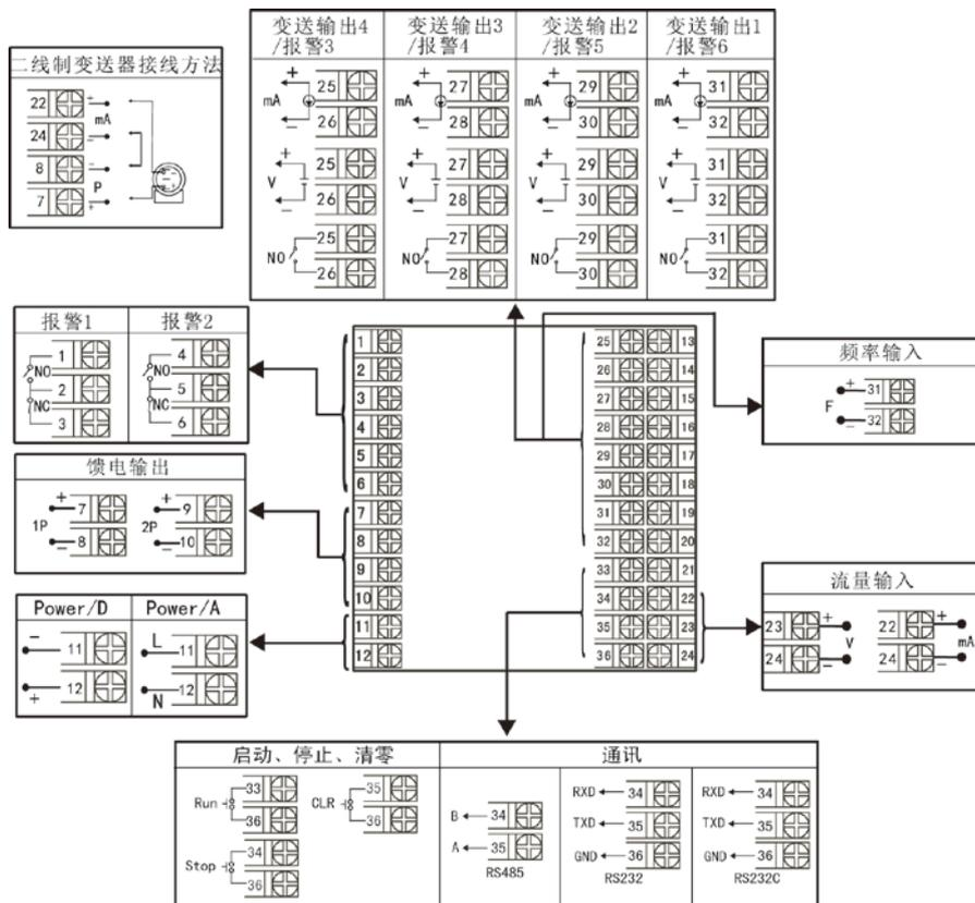
备注：接线图中在同一组端子标有不同功能的，只能选择其中一种功能如 RS485 和 RS232 在同一组接线端子上，只能选择一种。
