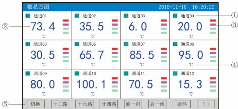
①：通道名称：表示显示通道对应的工程位号，可在通道组态中进行位号设置。
